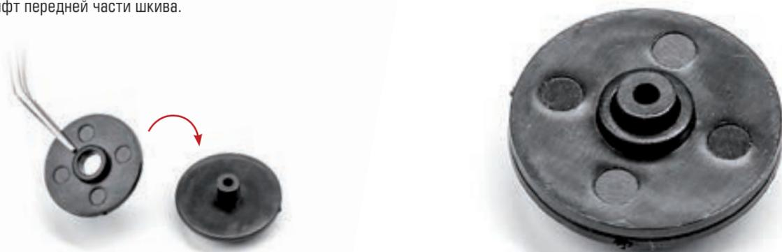
**Шаг 2.** На среднюю часть шкива сверху наденьте его заднюю часть. При этом плоская поверхность детали должна оказаться с внешней стороны собранного шкива.
