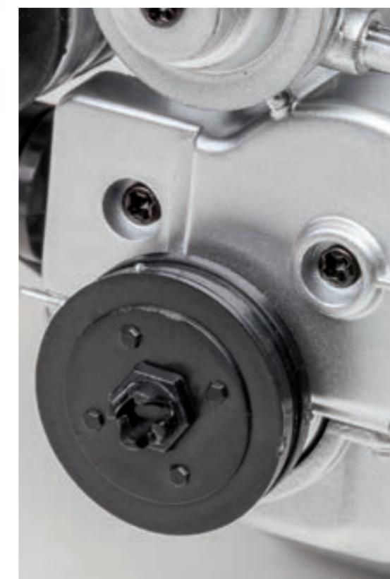
**Шаг 5.** Установите ремень на шкивы коленчатого вала, генератора и водяного насоса. Следите за тем, чтобы установленный ремень не перекручивался между шкивами.
